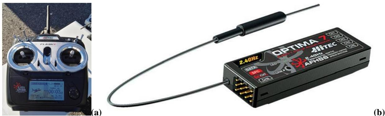
Figura 5.2-6: Trasmittente Hitec Flash 7 utilizzata e dettaglio dei pulsanti (a) e Ricevente Hitec Optima 7 (b).
