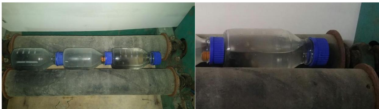
Figura 4.2-1: Prova norma UNI EN 12697-11
