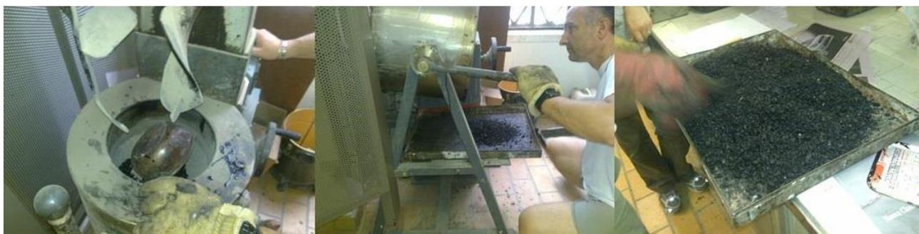
Figura 4.1-4: Le diverse fasi della preparazione dei conglomerati bituminosi: aggiunta bitume e miscelazione.
