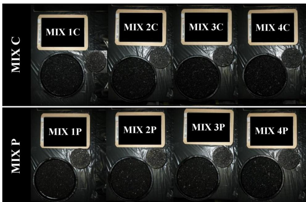
Figura 4.1-5: Conglomerati bituminosi costipati in provini di 10cm di diametro e in piatti di alluminio di 20cm di diametro.
