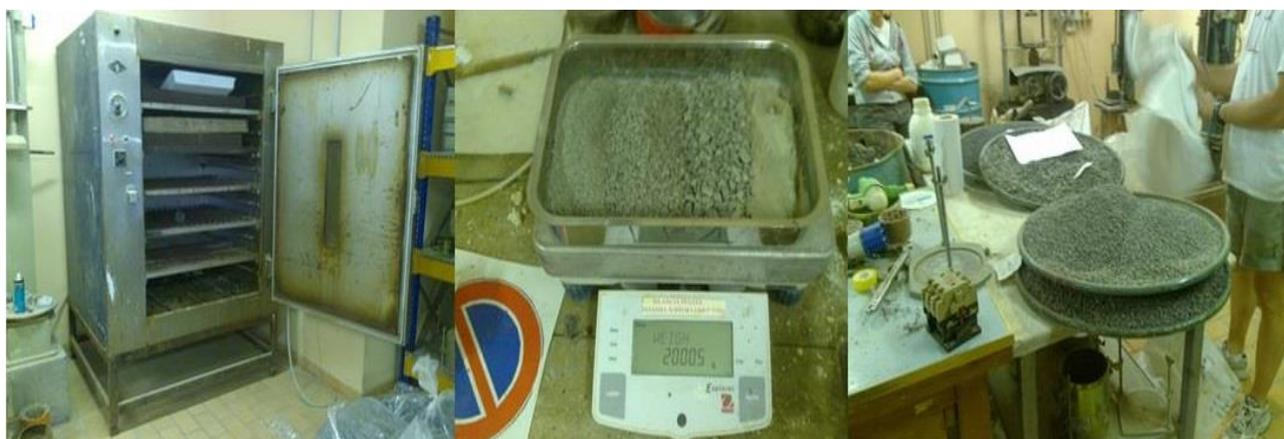
Figura 4.1-2: fasi della miscelazione degli aggregati ed essiccazione in forno
