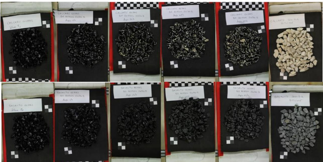
Figura 4.2-7: Dataset dei materiali derivanti dalle prove di adesione effettuate su calcare (sopra) e basalto (sotto)
