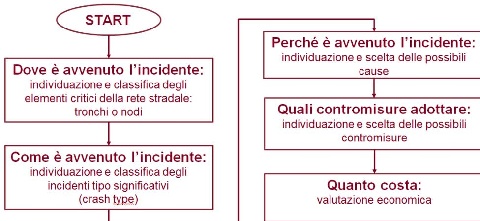
Figura 39 Diagramma di flusso generale del processo di scelta degli interventi
