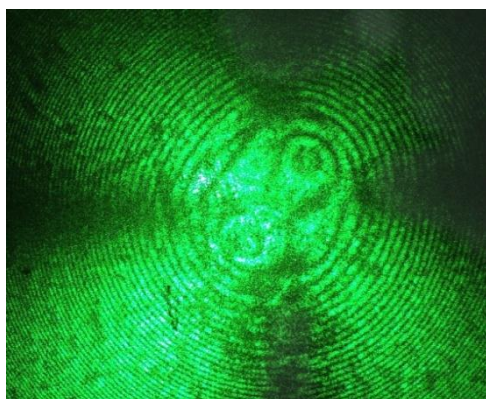
Р и с . 5 . Коноскопическая картина монокристалла ниобата лития. Угол аномальной двуосности 2V = 50'
