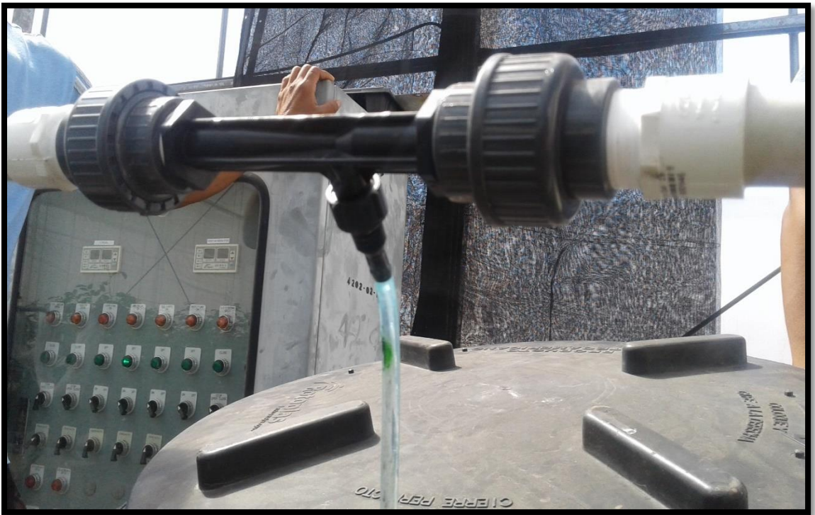
Imagen 11 (Venturi para insercion de fertilizante en el PIPIL)
