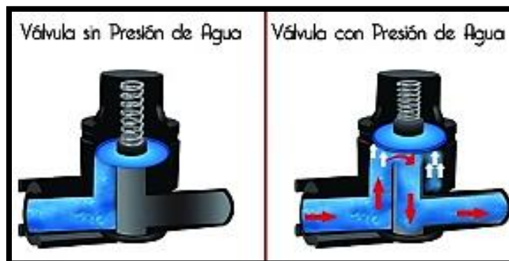
Figura 9 (Flujo de agua en los aspersores)
