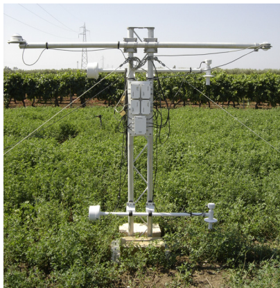
Figura 6.3 - Strumentazione di misura a supporto dello scintillometro
