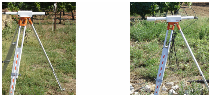
Figura 6.2 - Posizionamento del trasmettitore laser e del ricevitore nel campo coltivato a erba medica
