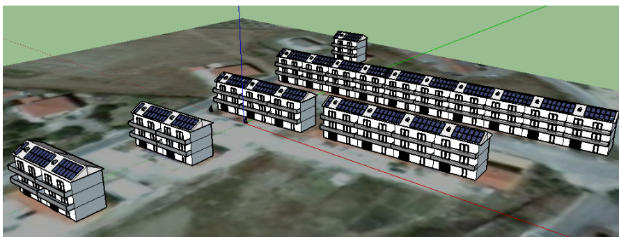
Figura 80. Distretto a BD con 100% di copertura della superficie utile dei tetti ( A_{ru} ) con pannelli FV.
