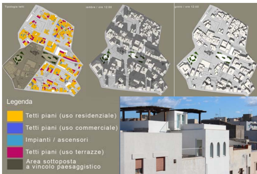
Figura 63. Studio solare: disponibilità delle superfici dei tetti all’installazione e studio degli ombreggiamenti, 15 Dicembre e 15 Agosto (Allegato multimediale di Riva Sanseverino, Riva Sanseverino e Vaccaro, 2014b)
