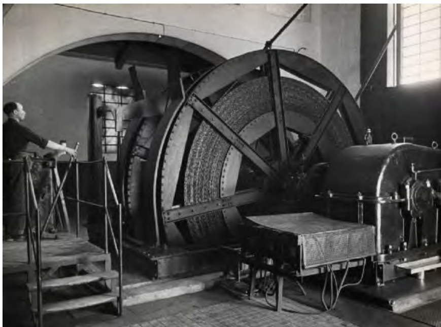
Grottafaldina. Interno del pozzo Mezzena: argano del castello di estrazione con un operaio al lavoro.
