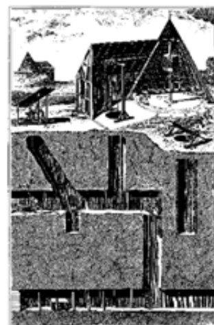
Sezione prospettica di una miniera e degli impianti di sollevamento, tratta dall'Encyclopedie
