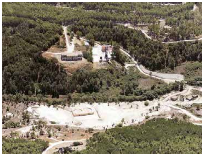
Un'immagine in cui si vede chiaramente l'impatto degli sterili di miniera sulla valle
