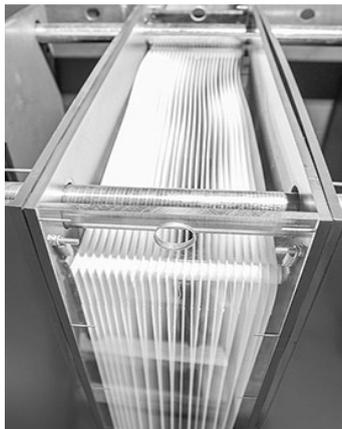
**Figura 6.6.** Esempio di modulo di membrane piane.
