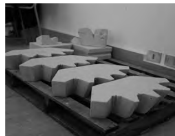
13-15. A sinistra, collegamento della sezione superiore e inferiore di alcuni elementi del tas-de-charge , al centro, definizione delle superfici a vista di un elemento del tas-de-charge ; a destra, i quattro filari n. 6 dei tas-de-charge pronti per la posa in opera.
