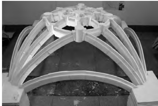
1. Modello riprodotto una volta sferica con costoloni dal trattato di Alonso de Vandelvira.
