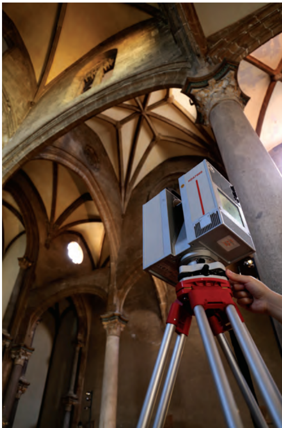
1. Rilevamento del sistema di copertura della Catena con laser scanner.
