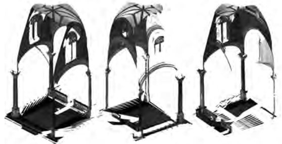
3. Confronto tra scansioni laser della volta, realizzate da tre distinti punti di stazione.
