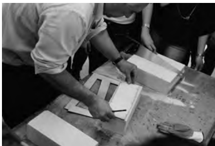
7. Tracciamento della faccia laterale del concio.
