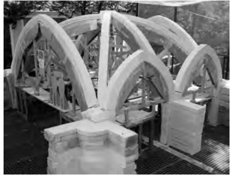
6. Modello di una delle volte esapartite delle quattro campate del refettorio del monastero di Santa Maria de Huerta
