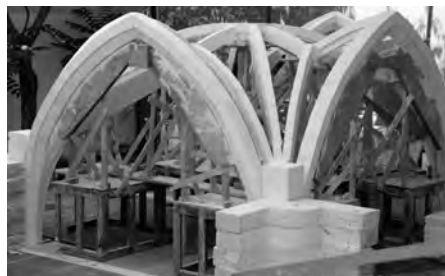
9. Modello della volta a cinque chiavi della crociera della cattedrale di Amiens.
