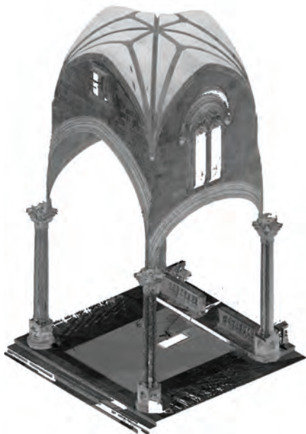
4. Orientamento e unione delle scansioni laser.
