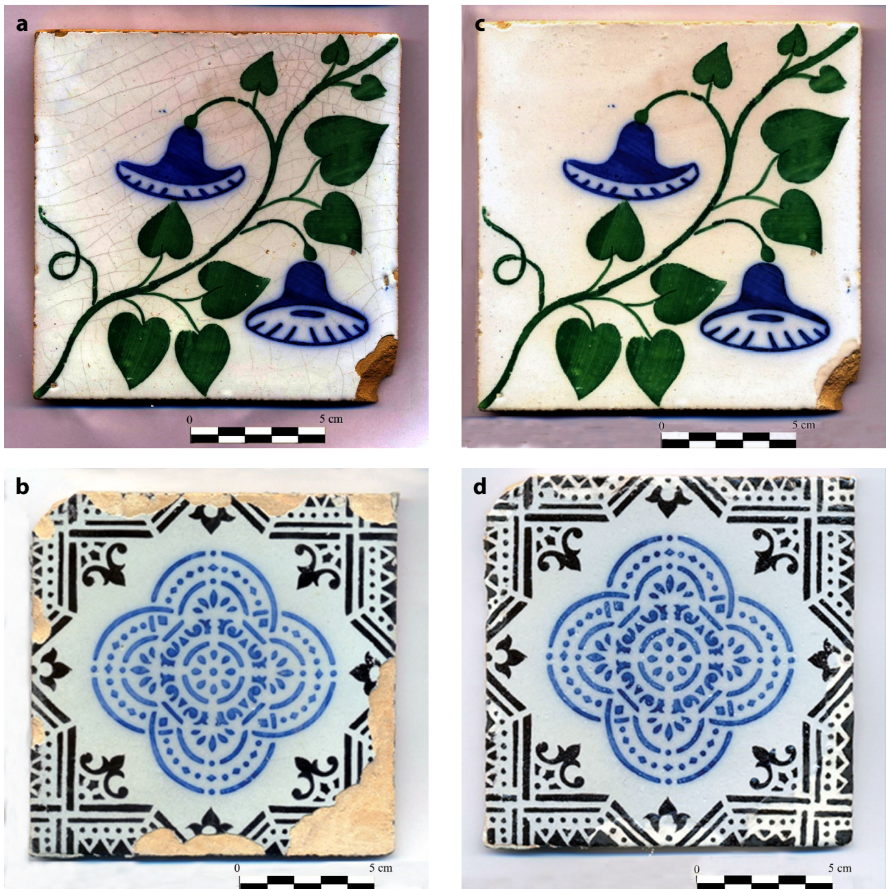
Figura 2. Os mesmos azulejos antes (a-b) e depois do restauro por recozimento a 890 °C com aplicação de novo vidrado (c) ou novo vidrado e pintura (d). Imagens: Antonina Chaban / LNEC, 2014.
