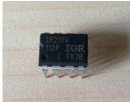
Fig.16- Mosfet Driver IR2014
