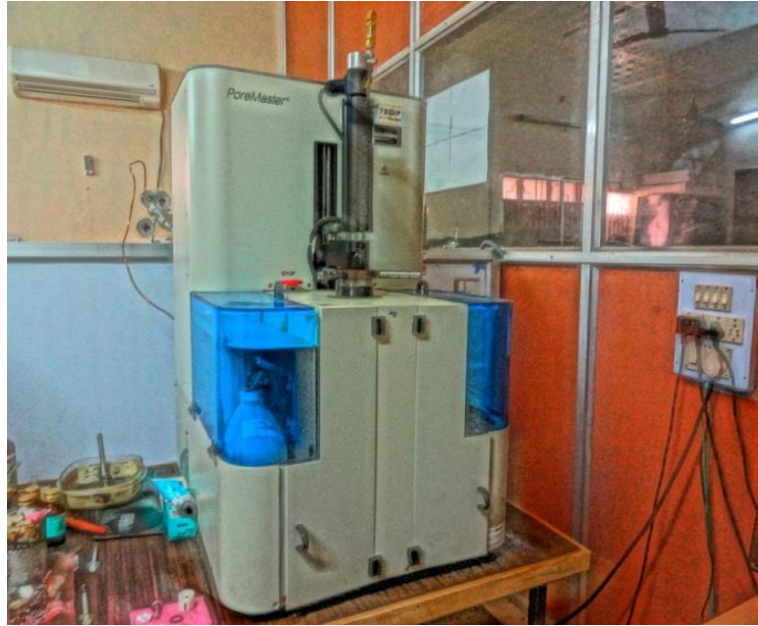
1.1.1.1.1.1.1 Figure3.10 Mercury intrusion porosimetry analyzer, Pore Master (PR-33-13)
