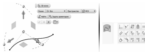
Рис. 6. Преобразование в трехмерный вид непосредственно из двухмерного режима.
