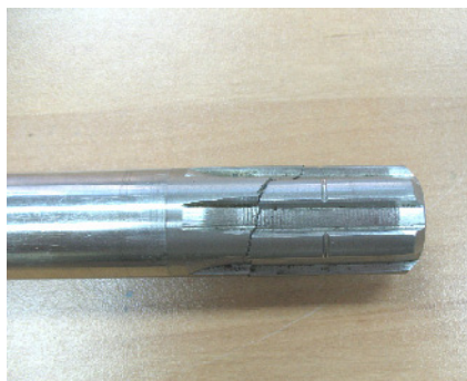
Рис. 1. Фрагмент шлицевого вала с трещиной
