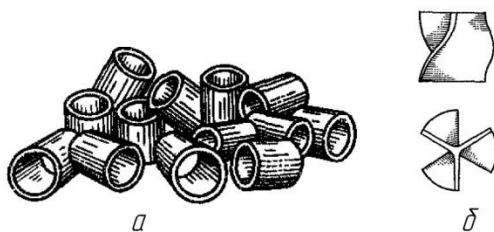
Рис. 2. Виды конструкций насадок: а – кольца Рашига; б – пропеллерная насадка [3]
