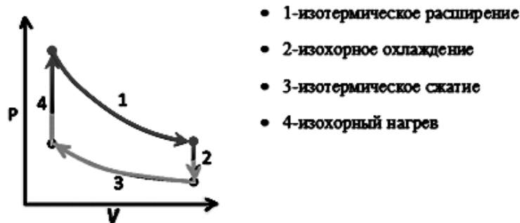
Рис.1. Термодинамический цикл Стирлинга
