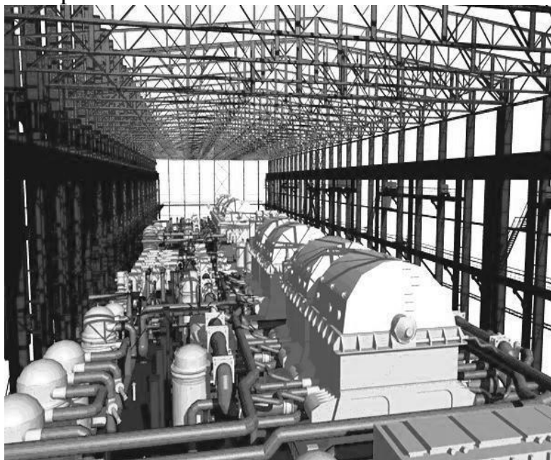
Рис. 1. Трехмерная модель оборудования машинного зала Ленинградской АЭС [5].
