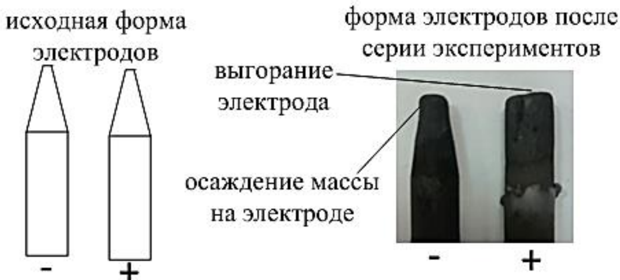
Рис. 2. Внешний вид электродов.
