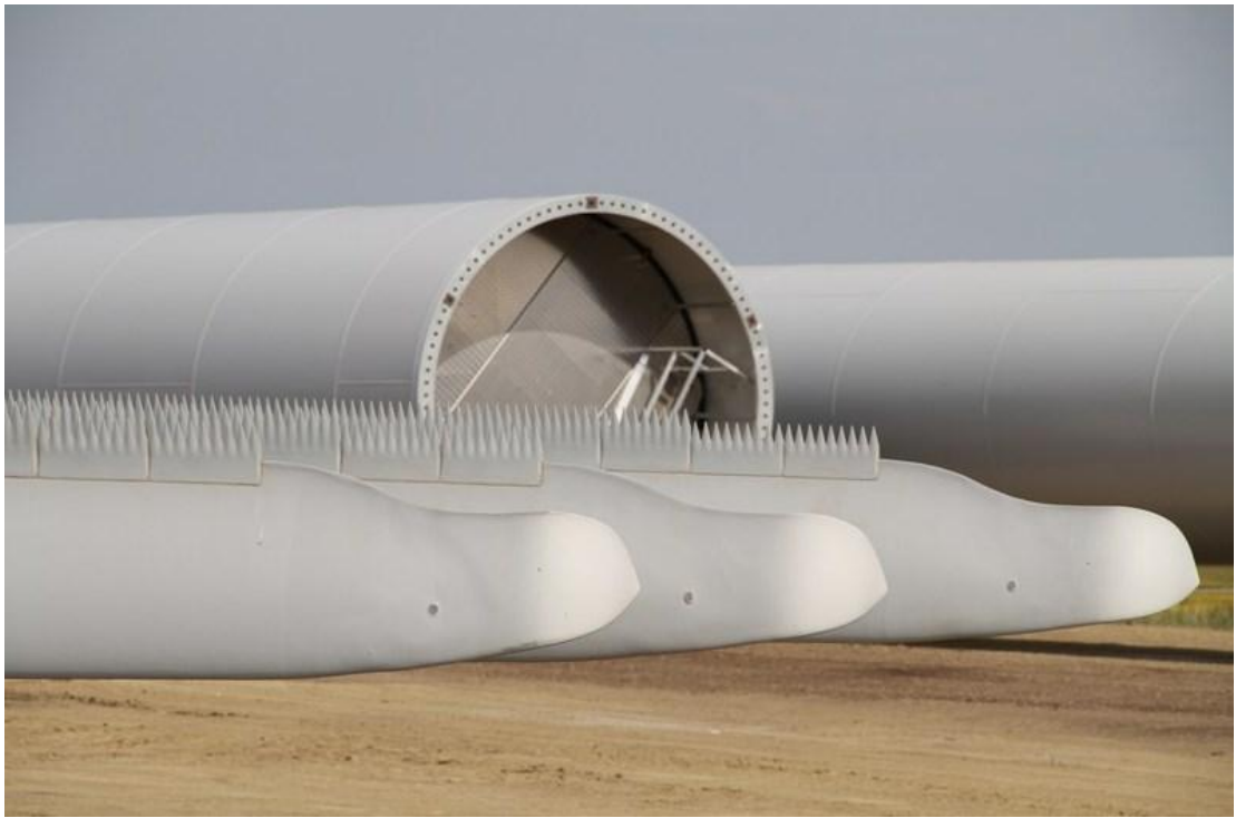
Рисунок 10.2 – Лопasti ветротурбины, оснащенные устройством шумоподавления
