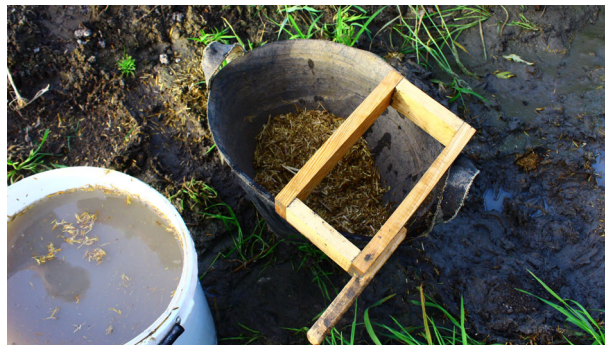
Ryc. 5. Składniki i narzędzia służące do produkcji cegły mułowej: woda, sieczka, muł oraz drewniana forma wykorzystywana do formowania cegieł Fig. 5. The components and tools for the production of mudbrick: water, chopped straw, mud and wooden mold used for molding bricks
