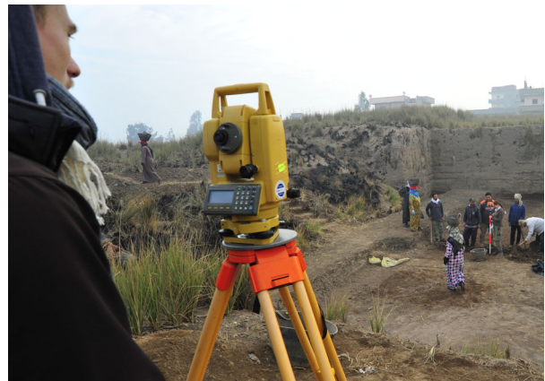
Ryc. 7. Pozyskiwanie danych tachymetrycznych podczas pracy na stanowisku archeologicznym Tell el-Farkha
