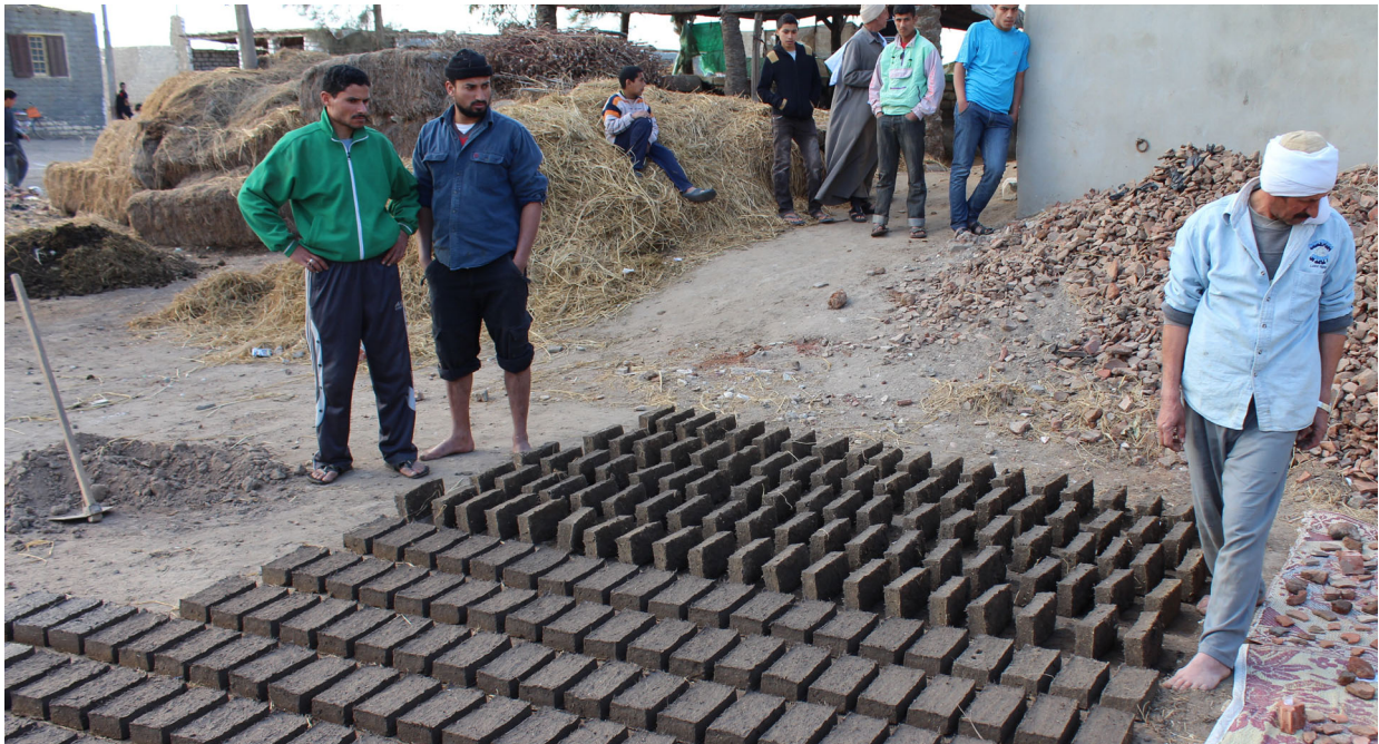
Ryc. 6. Proces suszenia cegieł mułowych. Na dalszym planie widoczne są cegły po 3 dniach suszenia – obrócone pod kątem 90 stopni, w celu zapewnienia lepszego wyschnięcia powierzchniom pierwotnie niewystawionym na działalność promieni słonecznych
