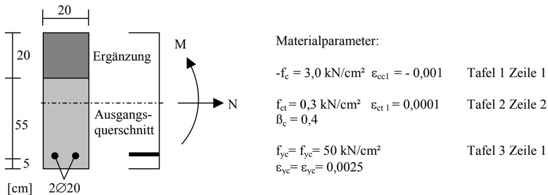
Abb. 1: Rechteckquerschnitt mit nachträglicher Ergänzung: Geometrie- und Materialparameter
