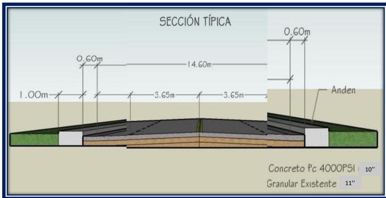
**Figura 51. Sección típica de la vía**
