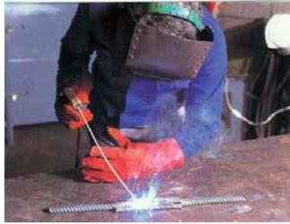
*Figura 14. Soldadura por traslape
