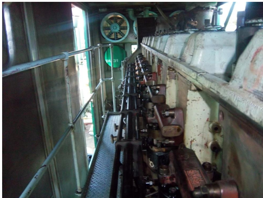
Anexos 15: Sistema de Regulación de Inyección de Combustible a los Cilindros.
