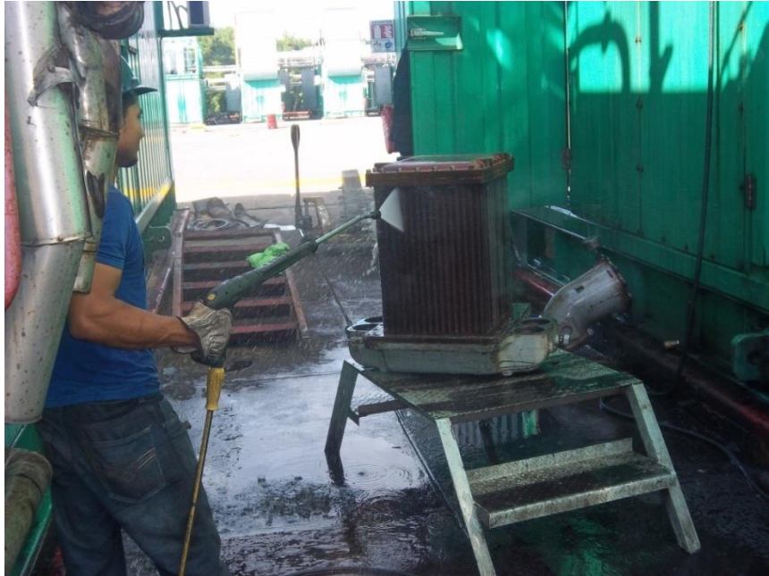
Anexo 12: Lavado de Radiador.
