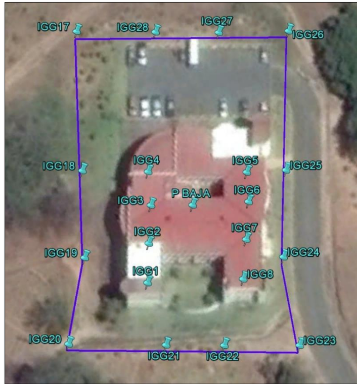
Figura 4.2. Ubicación de los puntos levantados en el edificio. Fuente: Software Google Earth Pro 7.2
