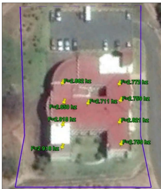
Figura 5.10. Frecuencias naturales de la estructura en la dirección EW, calculadas en MatLab R2015a. Fuente: Autores.
