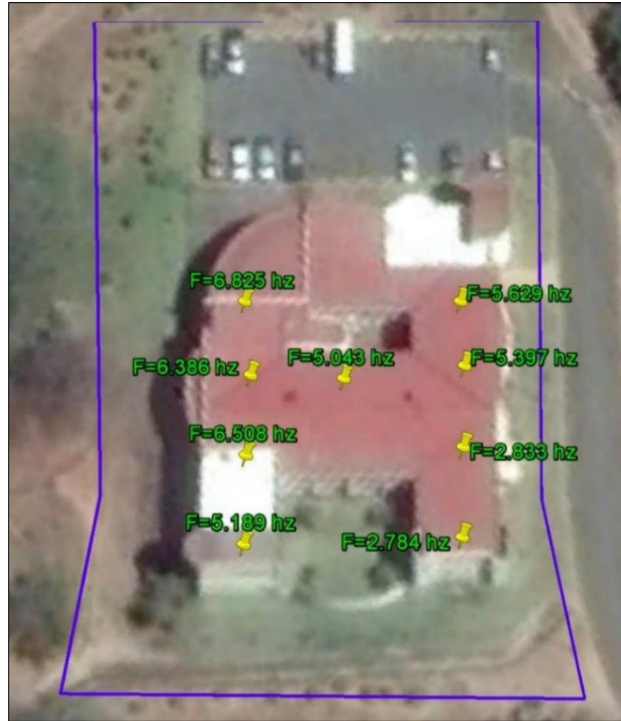
Figura 5.9. Frecuencias naturales de la estructura en la dirección NS, calculadas en MatLab R2015a.
