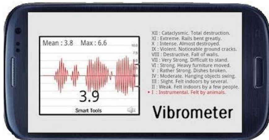
Figura 5.4.1 Aplicación del Vibrómetros en equipos celulares
