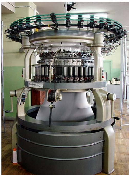
Rys. 62. Cylindryczna szydełkarka dwułożyskowa firmy Mayer & Cie: typ Ovja 36, numer uiglenia 20 E, liczba zamków z = 36 , liczba igieł I = 1872 , średnica cylindra \varphi = 30 \text{ cali}
