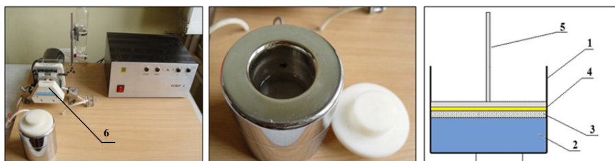
Rys. 83. Widok ogólny przyrządu pomiarowego SORP 3: 1 – komora pomiarowa, 2 – poziom cieczy, 3 – płytka Schotta – badana próbka, 5 – uchwyt do próbki, 6 – pompa perystaltyczna wg [125]
