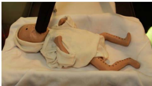
Rys. 109. Manekin termiczny dziecka urodzonego przedwcześnie wraz z funkcją wydzielania wilgoci w poszczególnych jego strefach anatomicznych
