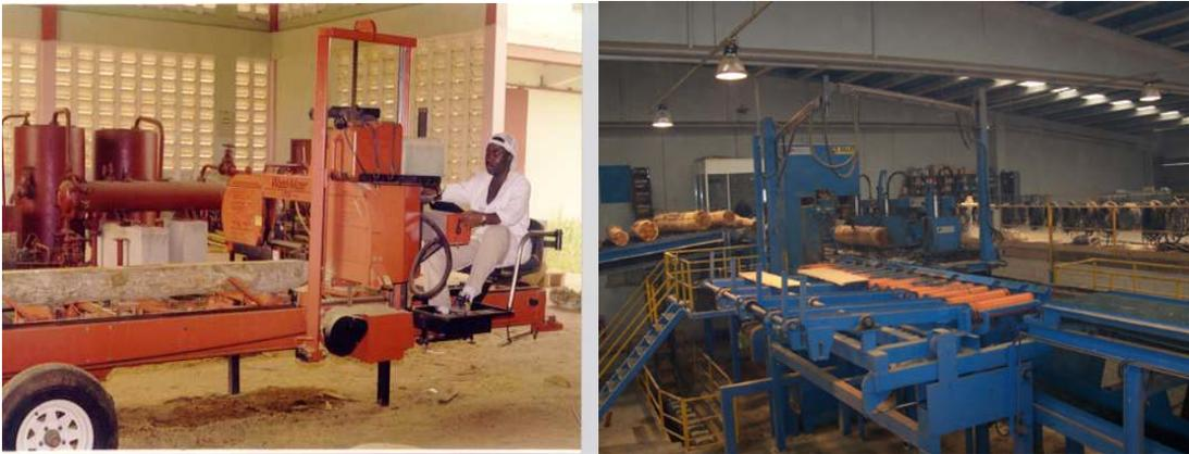
**Figura 2.3** a). Aserradero móvil horizontal. Fuente: Okay. 2001; b). Aserradero permanente. Fuente: Alvarez 2005
