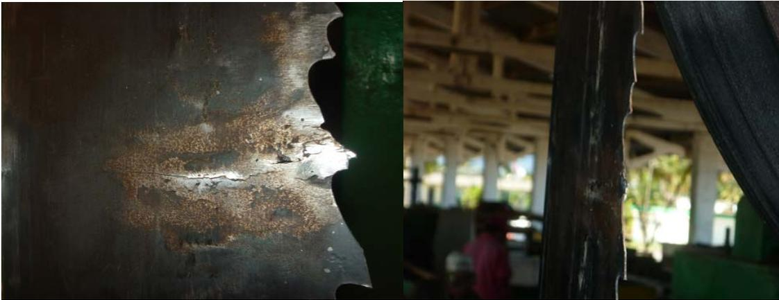
**Figura 3.4.** Estado en que se encontraban los dientes del sinfín en la máquina. Fuente. González, 2013.
