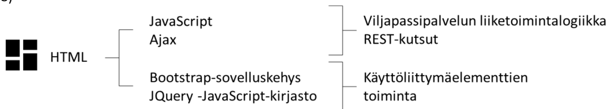
Kuva 9. Käyttöliittymä -web-sovelluksen sisäinen rakenne ylätasolla.
