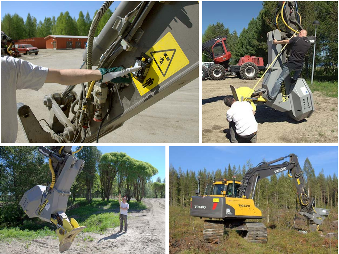
Kuvat 14 a–d. 3D-mittalaitteisto asennettiin ja kalibroitiin PKKY:n Valtimon yksikössä toukokuussa 2013 (kuvat Miia Parviainen/Metla).
