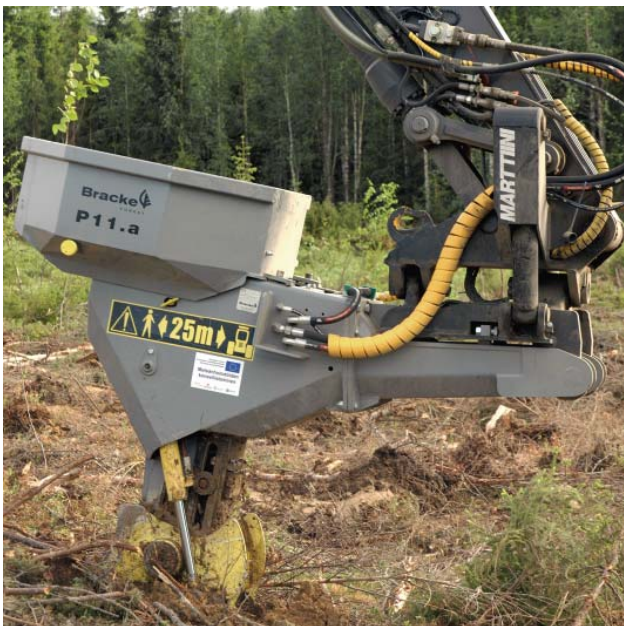
Kuvat 12 a ja b. Taimet istutettiin Bracke P11.a istutuskoneella, jonka taimikasettiin mahtuu 72 tainta.
