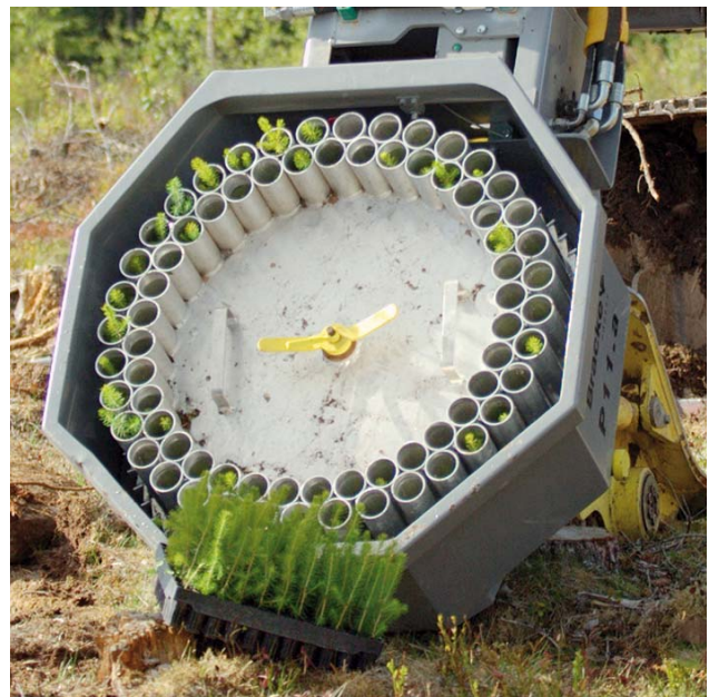
Kuvat 12 a ja b. Taimet istutettiin Bracke P11.a istutuskoneella, jonka taimikasettiin mahtuu 72 tainta.
