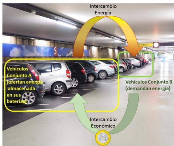
Figura 1. Esquema del sistema peer to peer para compartir energía entre VE.
