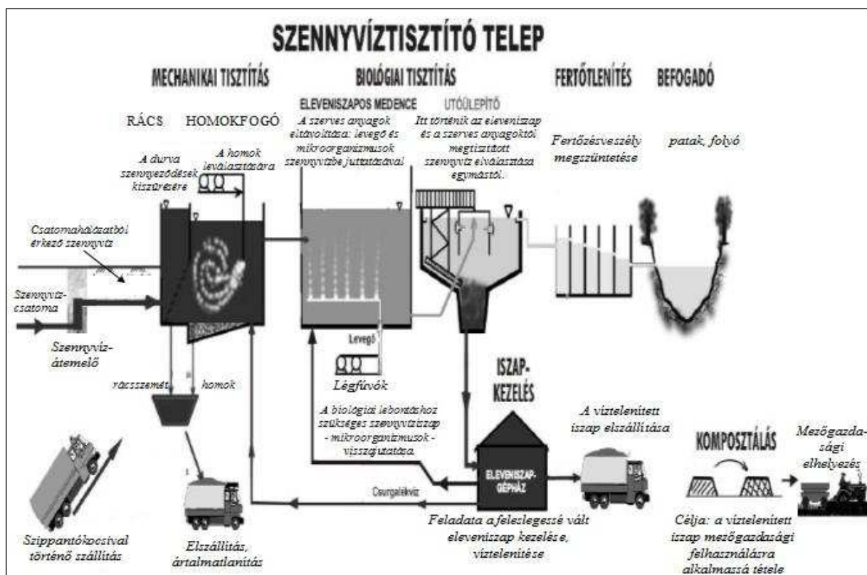
1. ábra: A szennyvíztisztítás folyamata
