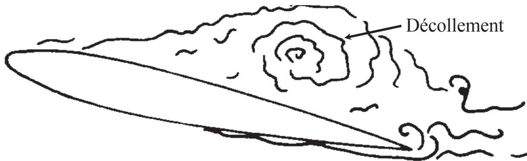
Figure 1.3 Mécanisme de génération du bruit large bande : décollements locaux [19]
