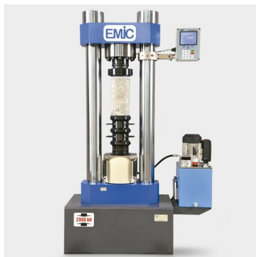
Figura 25 - Prensa hidráulica para uso em ensaios a compressão não confinados.
