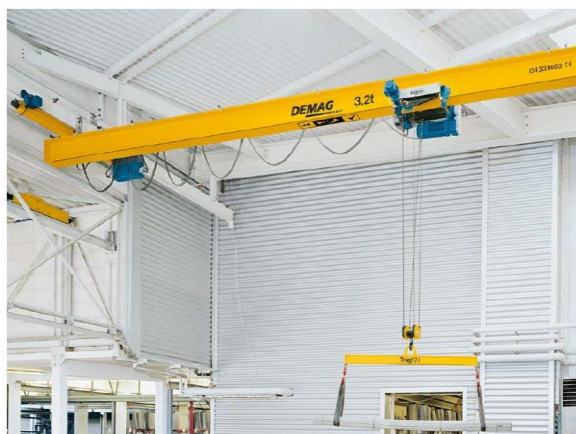
Figura 3 - Ponte rolante univiga suspensa
