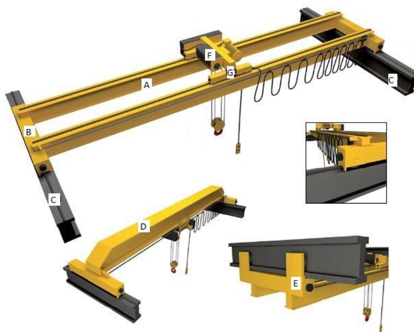
Figura 6 - Representação dos principais componentes de uma ponte rolante
