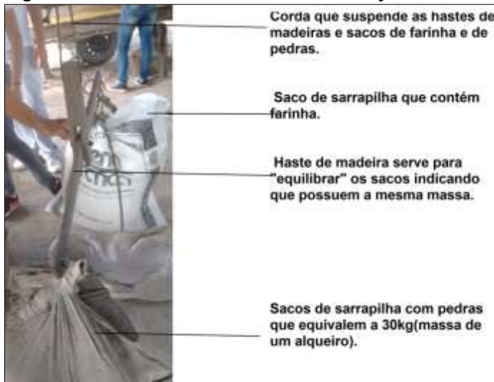
Figura 26 – Funcionamento da balança artesanal da casa de forno
