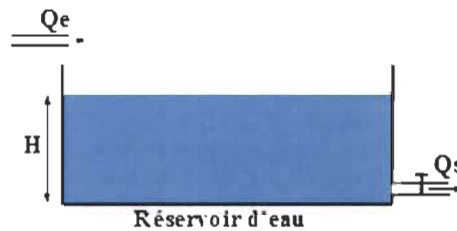
Fig. 3.12 : Réservoir de stockage d'eau
