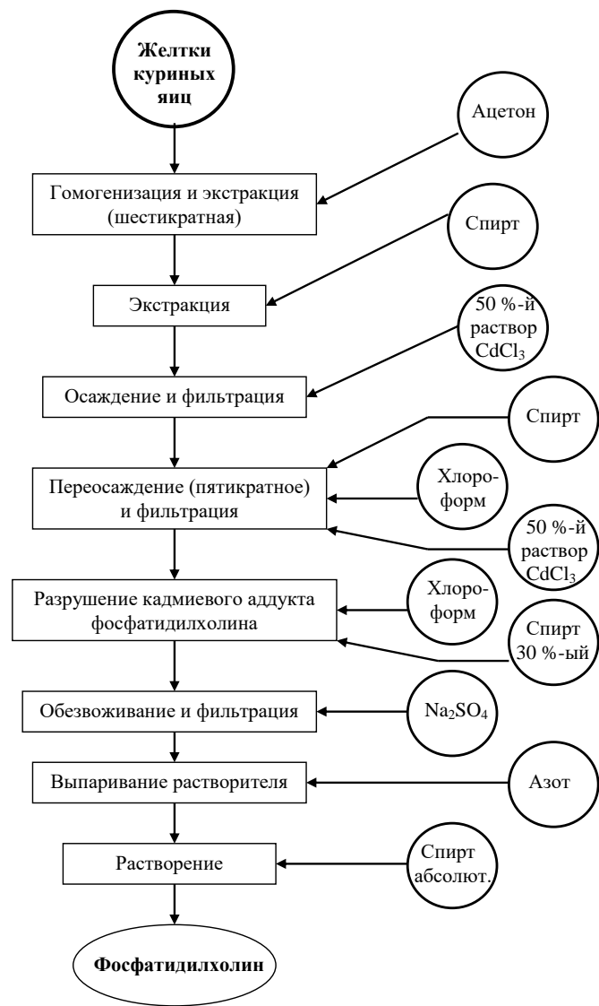
Рисунок 6 – Схема промышленного способа выделения природного фосфатидилхолина
