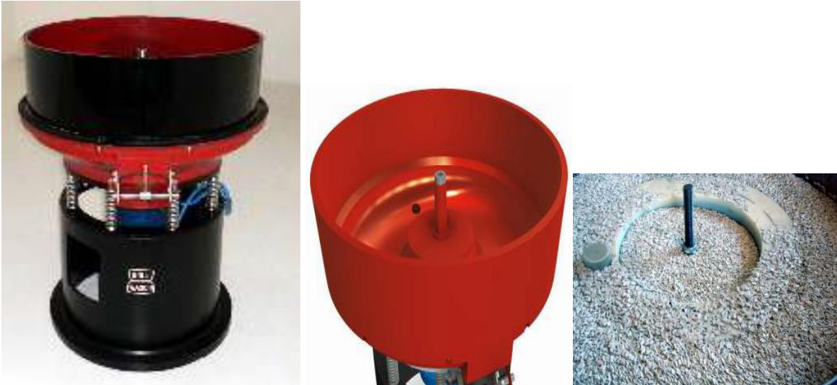
Figura 44: Buratto Superminor SMR- D-120-SF+, albero di centraggio e fissaggio asportabile, componenti abrasive
