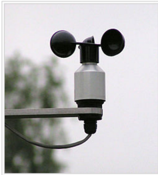
fig 2.1: struttura di un anemometro meccanico.[2]
