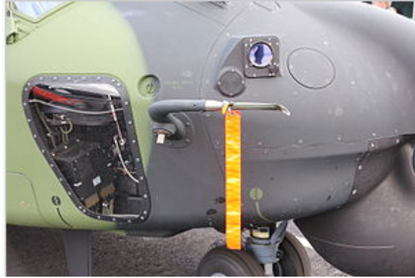
fig 2.4: tubo di Pitot montato su un NH-90 [2].
