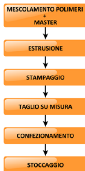
Figura 4.4. Schema a blocchi del processo produttivo del sottomano SKRUTT. (Elaborazione personale. Fonte: dati primari dal produttore).
