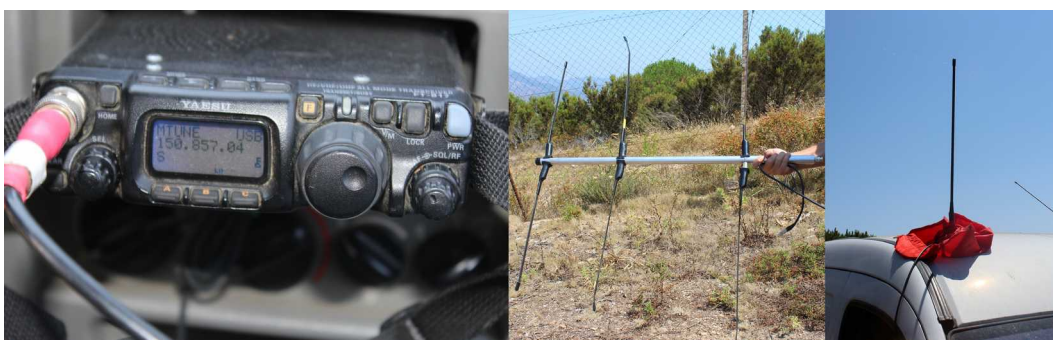
Figura 29: Materiale utilizzato nell'attività di radiotracking. A sinistra la ricevente Yaesu FT-817, al centro l'antenna Yagi a tre elementi e a destra l'antenna omnidirezionale applicata sull'autovettura. Foto Studio Agrofauna – Chiara Mencarelli.
