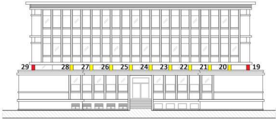
Figura 4.34: Prospetto Nord del padiglione B con evidenziati i pilastri tozzi sollecitati maggiormente a taglio
