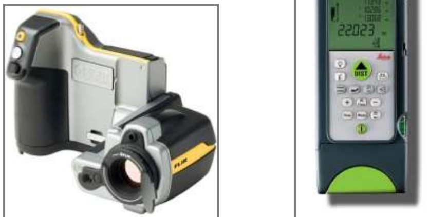
Figura 2.13: Alcuni strumenti utilizzati per il rilievo geometrico e strutturale Termocamera Flir B335 (a sinistra,) Disto Leica classic 5a (a destra)
