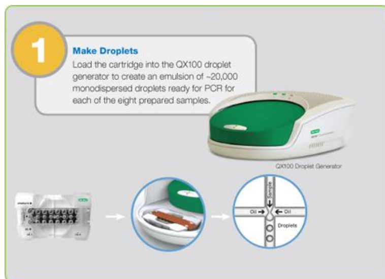
Figura 17. Meccanismo di formazione delle gocce
