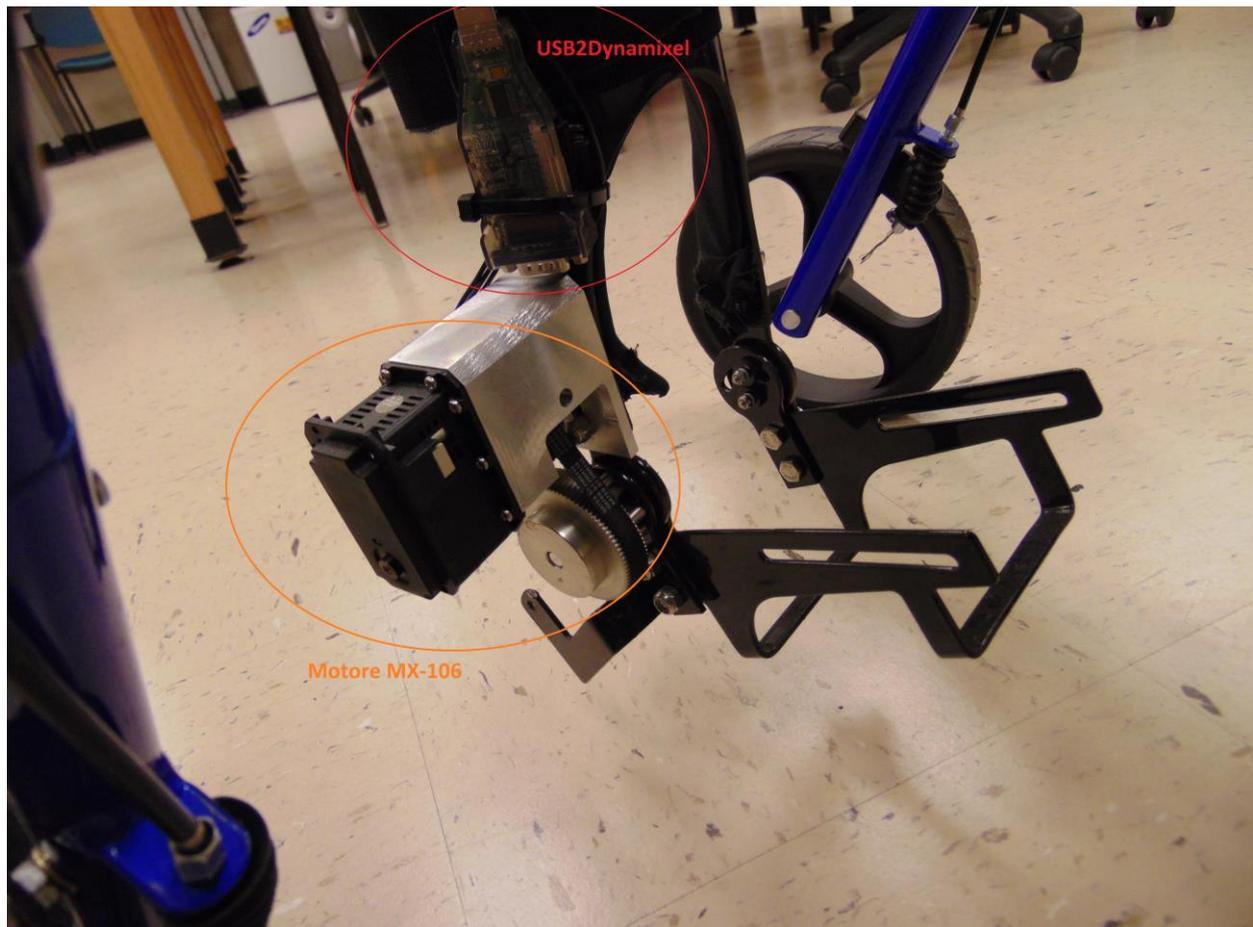
*Fig. 3.06 Motore DC MX-106 utilizzato come giunto attuatore per la caviglia.*
