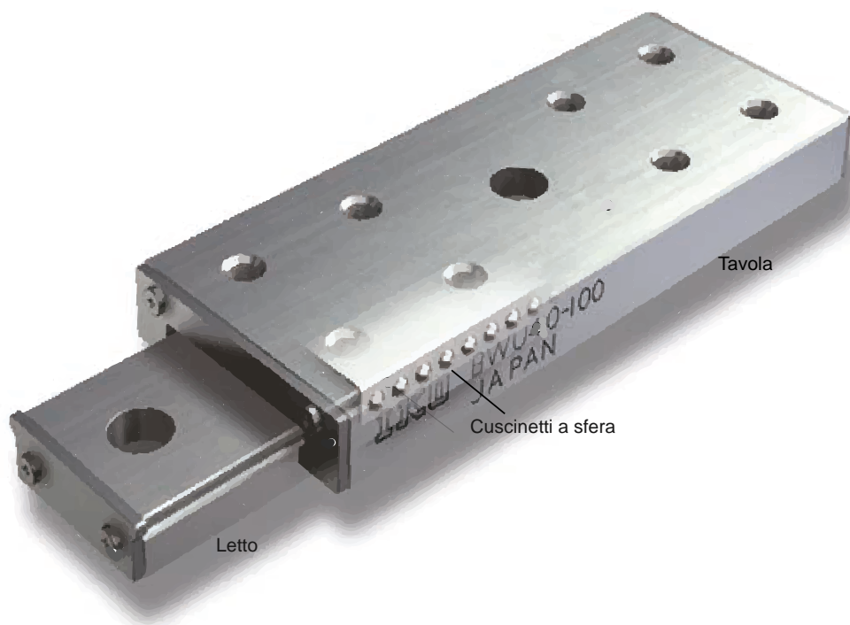
Figura 3. 6 Foto della slitta IKO-BWU 40-100; differisce dalla slitta IKO-BWU 40-80 solo per la lunghezza ( 100 mm invece di 80 mm , rispettivamente). Il carrello con i cuscinetti a sfera è montato all'interno della struttura, a favorire lo scorrimento del letto sulla tavola (la slitta è indicata nel testo con 'SL') [Illustrazione tratta e modificata da [72]].
