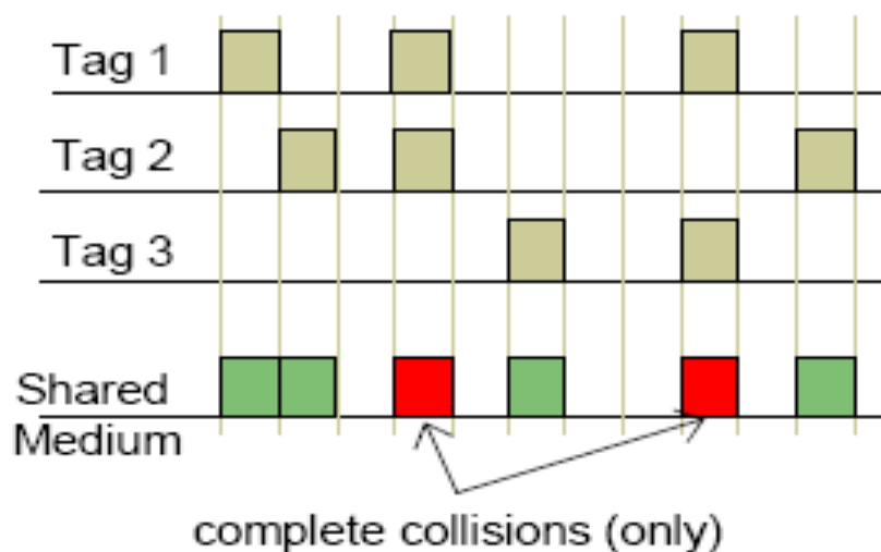
Figura 11 Collisione nello Slotted-Aloha [Burd2004]
