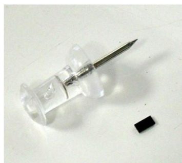
Figura 2 TITAN, un tag passivo UHF EPC global estremamente miniaturizzato, IDNOVA
