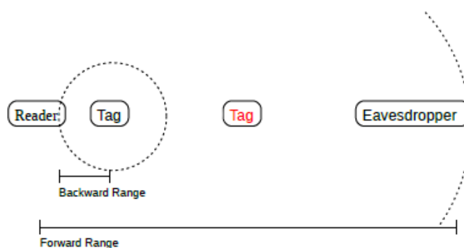
Figura 25 Forward vs. Backward Channels: Il reader può rilevare solo il tag che è nel backward range, ma non il tag in rosso. Un eavesdropper che è distante può intercettare il forward channel ma non le risposte del tag.
