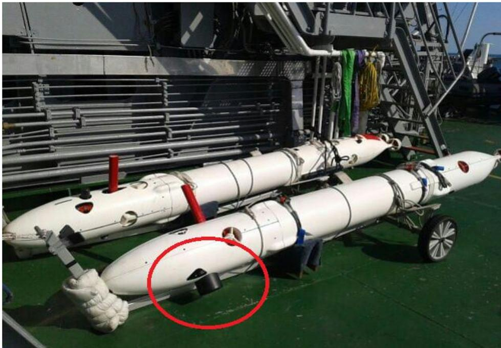
Figura 5: Esempio di installazione del modem Evo Logics su AUV
