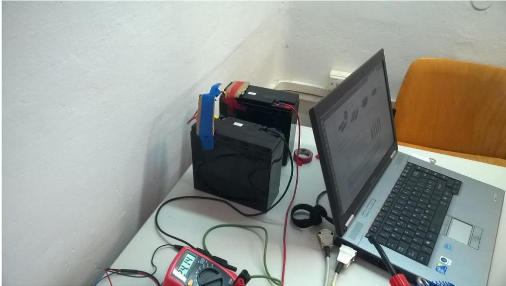
*Figura 8: Batterie in serie per l'alimentazione dei modem*
