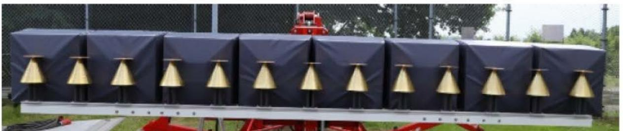
*Figura 1.12: Array di antenna composta da 13 elementi equispaziati*
