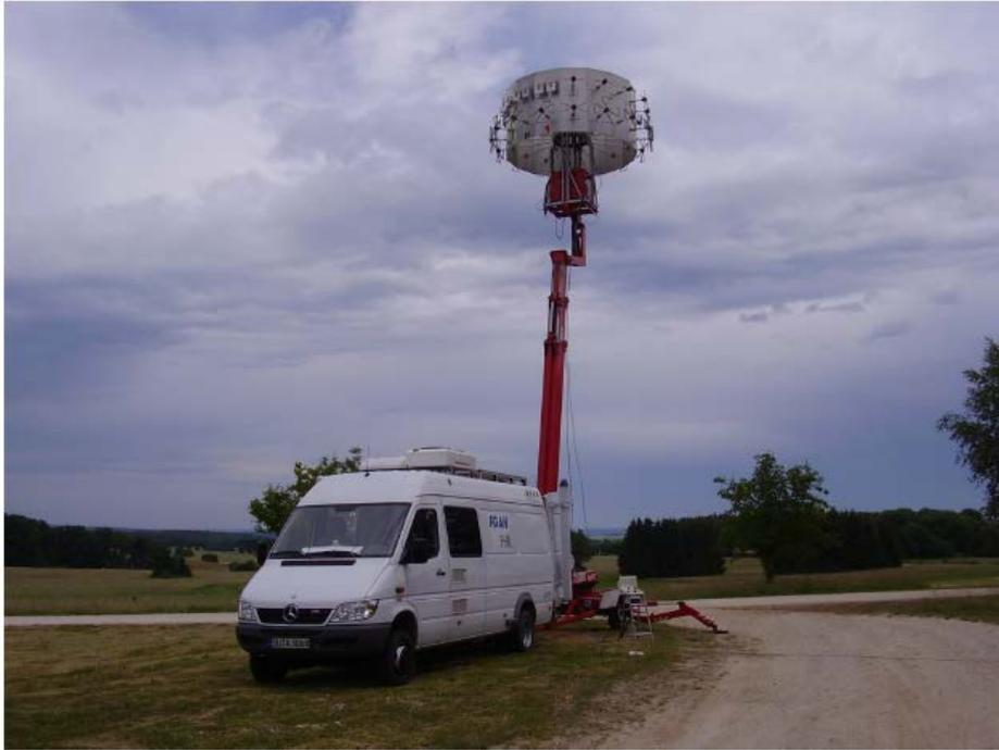
*Figura 1.11: Van completo dell'albero e del gruppo antenne*
