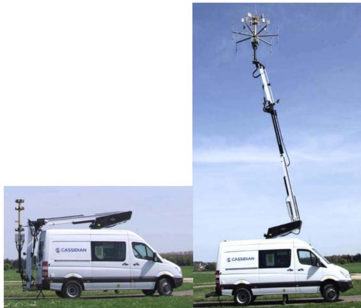
*Figura 1.7: Van contenente l'attrezzatura elettronica e l'albero di sostegno del gruppo antenne*
