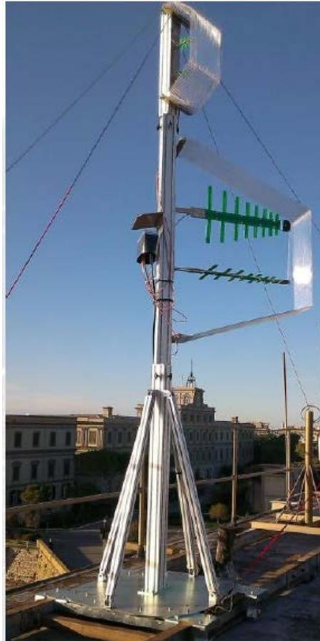
*Figura 2.4: Antenne per la ricezione del segnale di riferimento*
