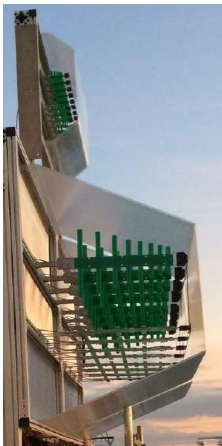
*Figura 2.3: Array di antenne per la ricezione del segnale dalla zona di sorveglianza*
