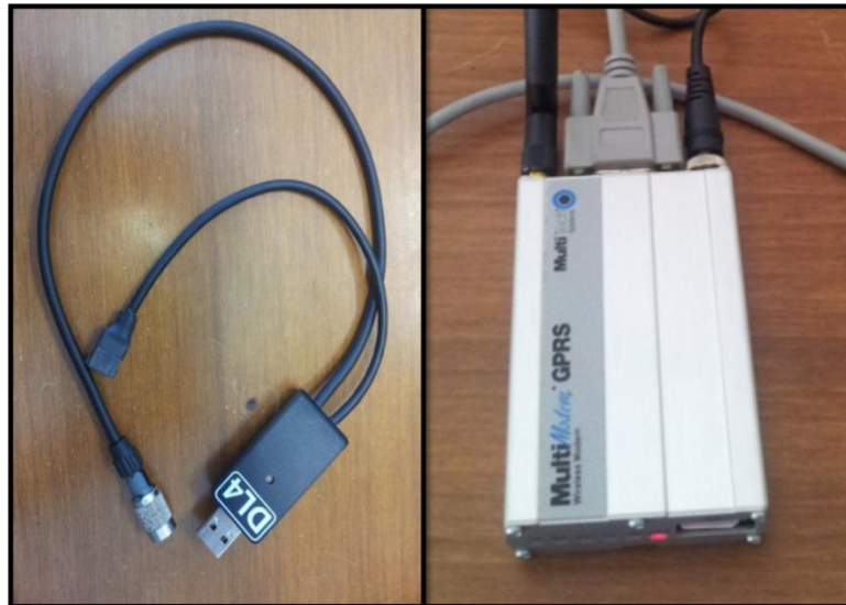
Figura 17: Cavetto DL4 (a sx) e Groud Station (a dx) forniti dalla casa produttrice a corredo del radiocollare
