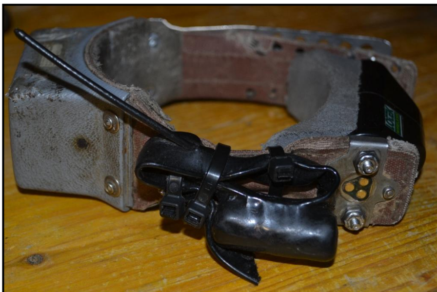
Figura 24: Radiocollare GPS con integrato il radiocollare VHF che è stato applicato all'istrice oggetto di studio. Si può notare che i due radio collari sono tenuti uniti da dalle fascette.
