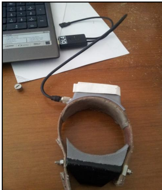
Figura 20: Particolare del radiocollare collegato al computer tramite cavetto DL4, si può notare il nastro bianco che tiene alloggiato il magnete sul radiocollare
