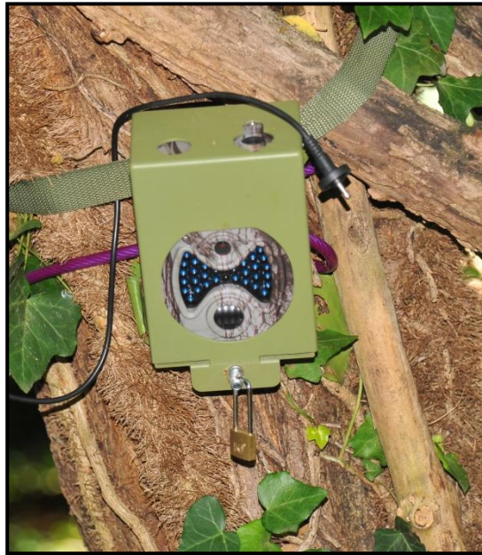
Figura 77: Fototrappola Boskon Guard BG-530 posizionata nell'area di studio e dotata del box antifurto, è visibile il cavetto di alimentazione temporaneamente scollegato
