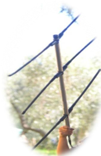
Figura 31: Antenna Yagi a 3 elementi utilizzata per la localizzazione dell’animale con la tecnica dell’ homing-in
