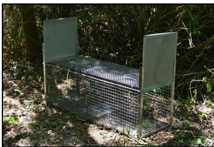
Figura 41: Trappola di cattura a doppio ingresso con pedana centrale basculante
