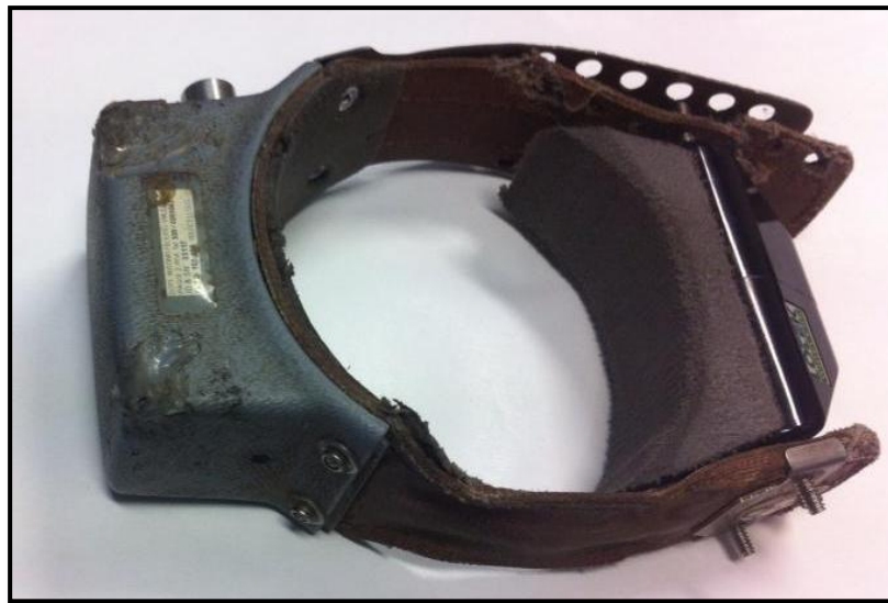
Figura 15: Radiocollare GPS con tecnologia GSM della Lotek
