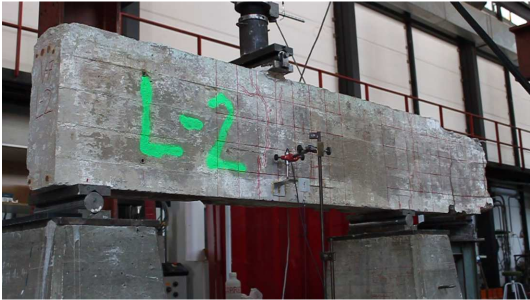
Figura 3.11 – Foto di una trave sottoposta a prova di carico a 3 punti
