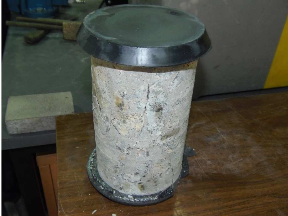
Figura 3.14 b) – Provino di calcestruzzo a seguito di una prova compressione
