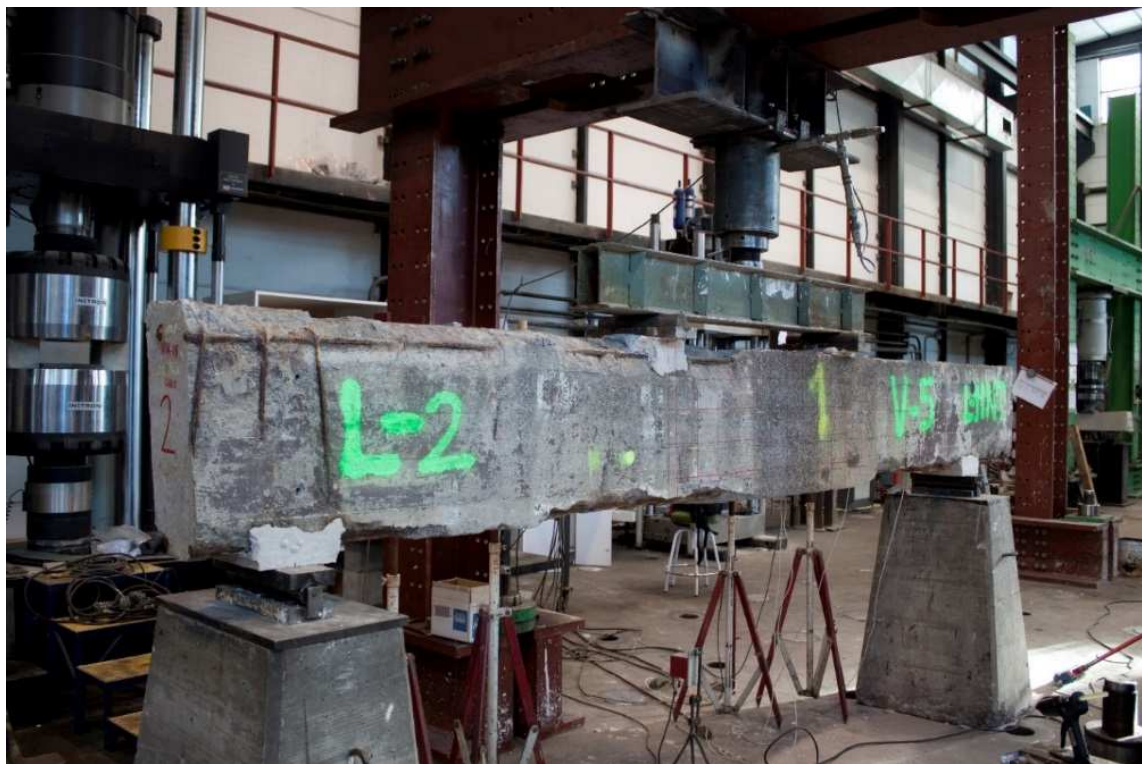
Figura 3.9 – Foto di una trave sottoposta a prova di carico a 4 punti
