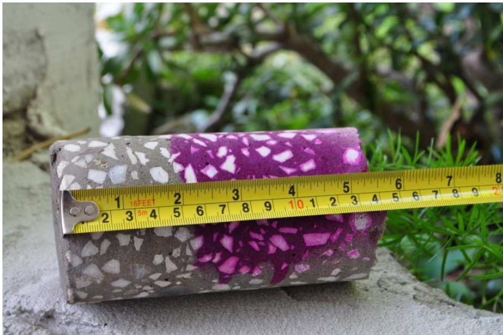
Figura 2.5 – Determinazione del fronte carbonatato mediante fenolftaleina
