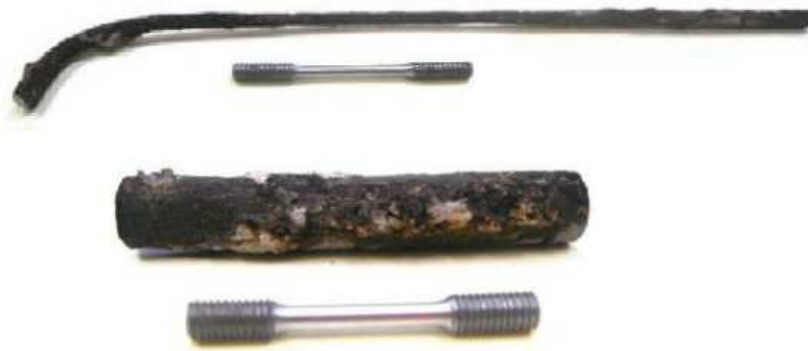
Figura 3.15 – Geometria di campione estratto da uno spezzone di armatura
