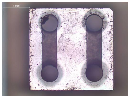
*Figura 4.13: Foto al microscopio ottico della faccia inferiore del "Fungo".*
