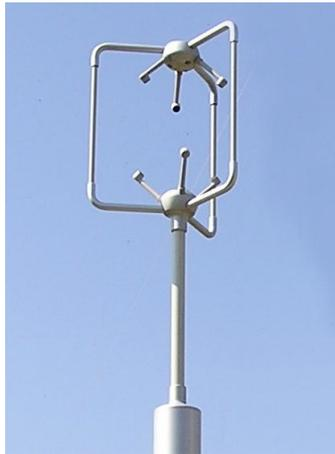
*Figura 1.2: Foto esemplificativa di un'architettura anemometrica ad ultrasuoni.*
