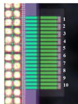
Figura 3.28: Foto al microscopio ottico di una termopila in cui è stato messo in evidenza il numero di termocoppie costituenti.
