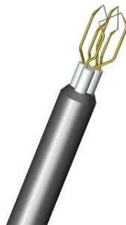
*Figura 1.3: Esempio di un anemometro a filo caldo, rappresentazione dell'estremità finale con il filamento.*
