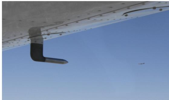
*Figura 1.4: Foto di un tubo di Pitot di equipaggiamento ad un aeromobile.*
