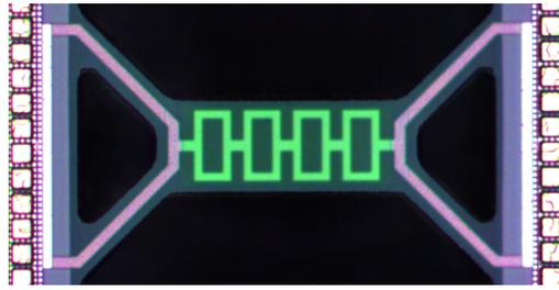
Figura 3.33: Foto al microscopio ottico di un riscaldatore.
