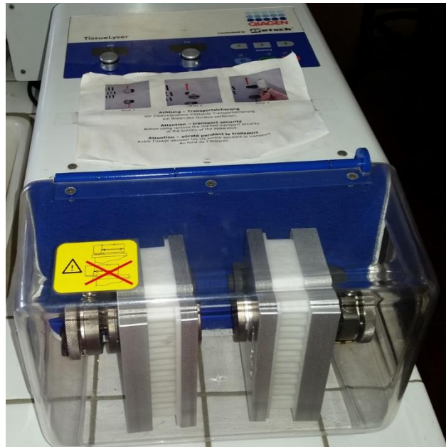
Figura 8. TissueLyser, strumento che permette la macinazione simultanea di più campioni.
